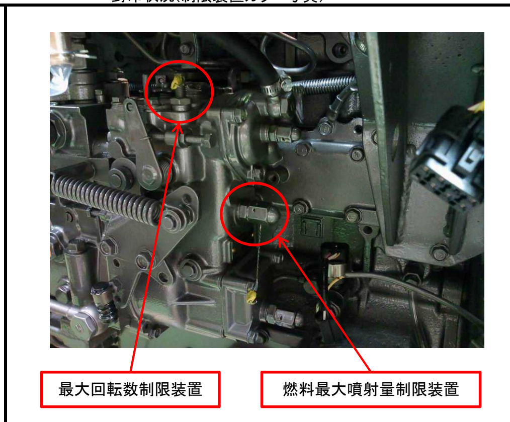
封印状況(制限装置カラー写真)
