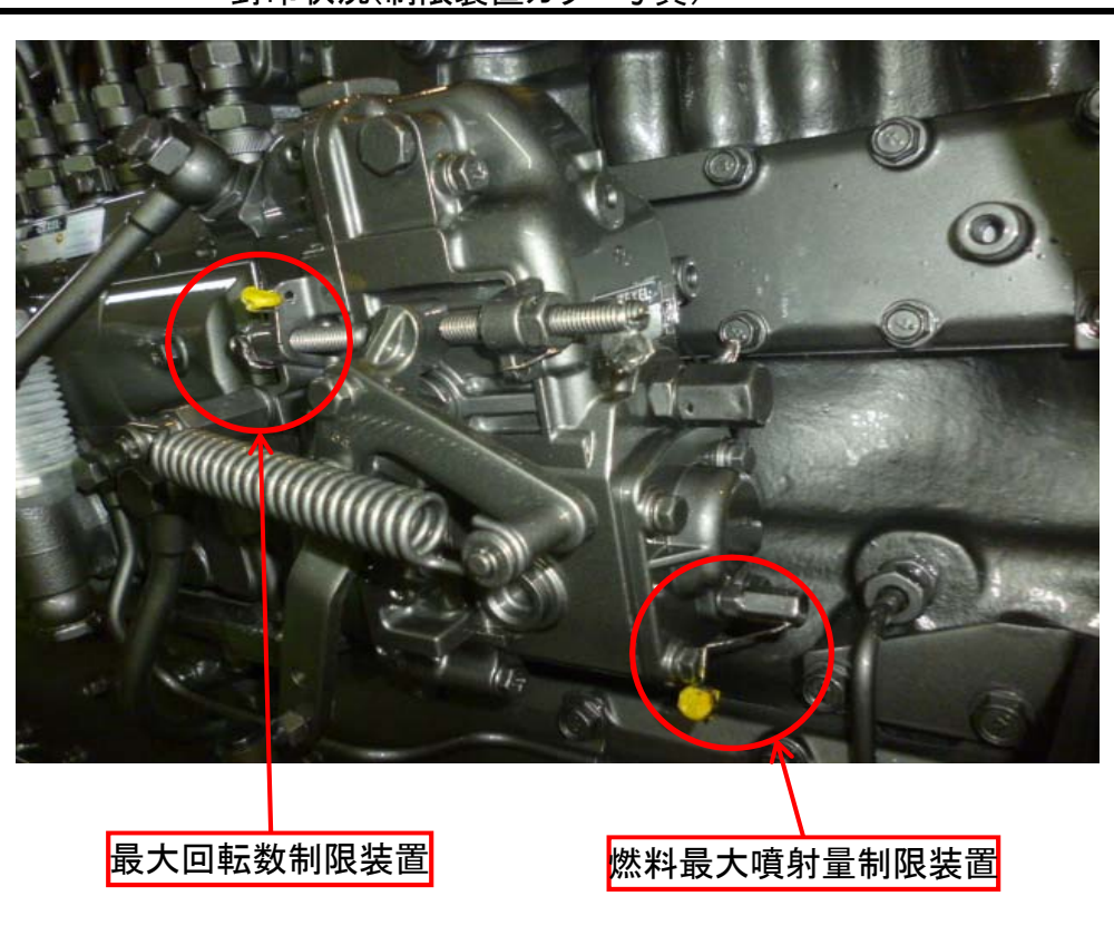
封印状況(制限装置カラー写真)
