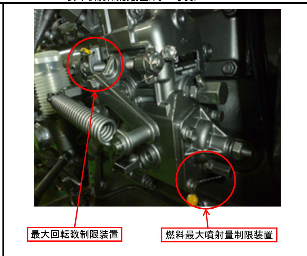
封印状況(制限装置カラー写真)
