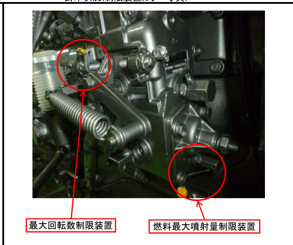
封印状況(制限装置カラー写真)
