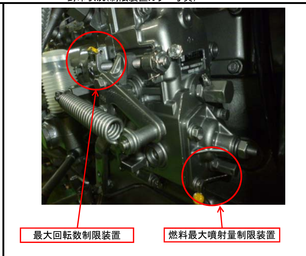
封印状況(制限装置カラー写真)
