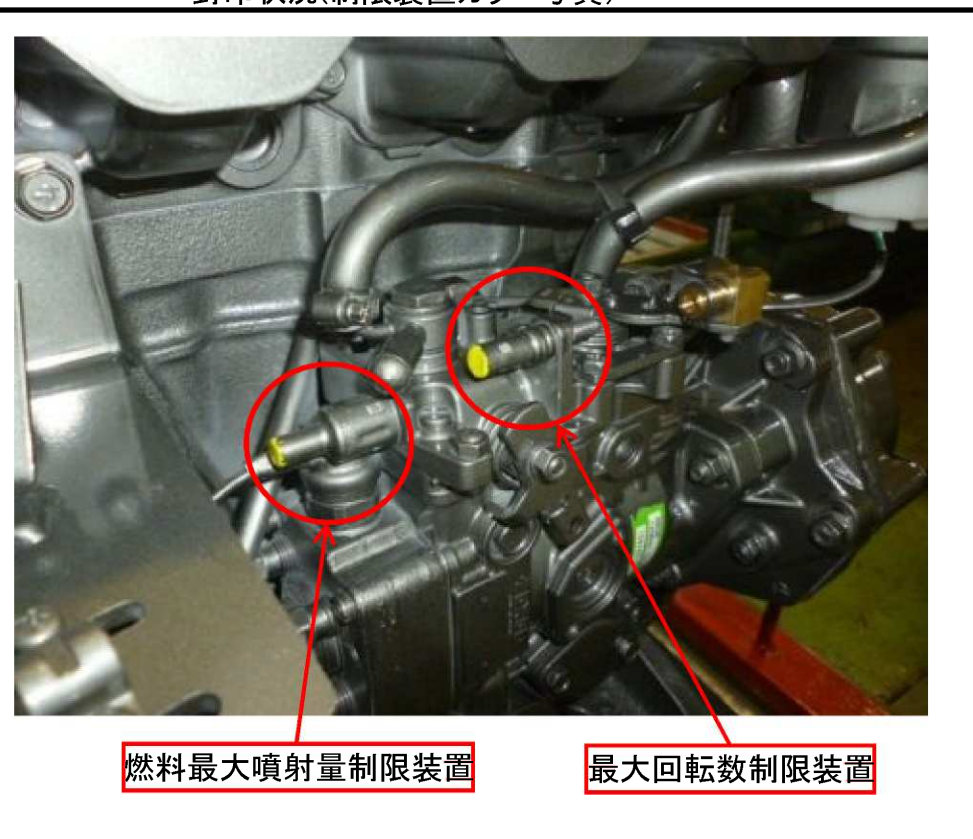
封印状況(制限装置カラー写真)
