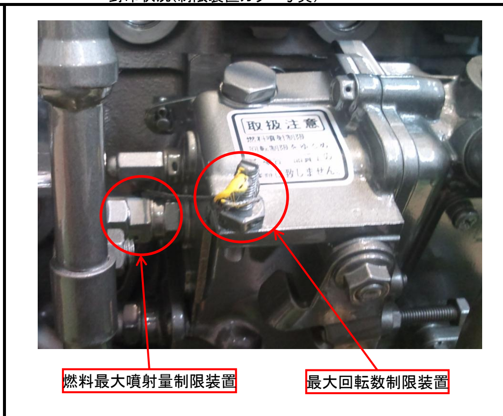
封印状況(制限装置カラー写真)
