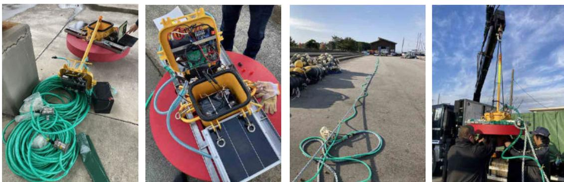
図表 5. II-6 開発した水中映像伝送システムとその設置作業準備
