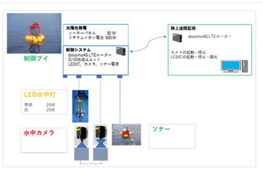
図表 5. I-1 モニタリングシステムの構成
