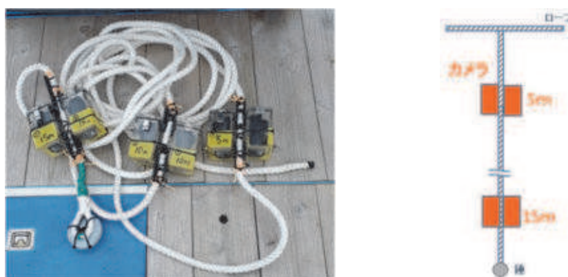
図表5-4 第一箱網に取り付けるカメラと模式図
