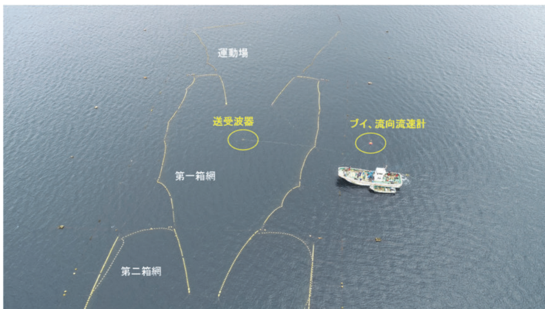
図表5(1)3.① ユビキタス魚探の各機器と設置位置
