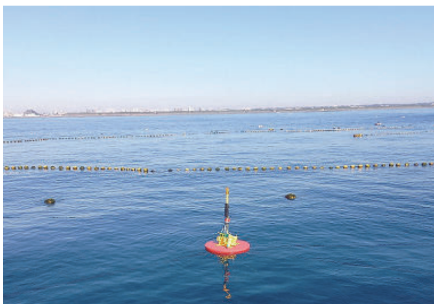
写真 6-5 川長水産 第一箱網に設置されているユビキタス魚探
