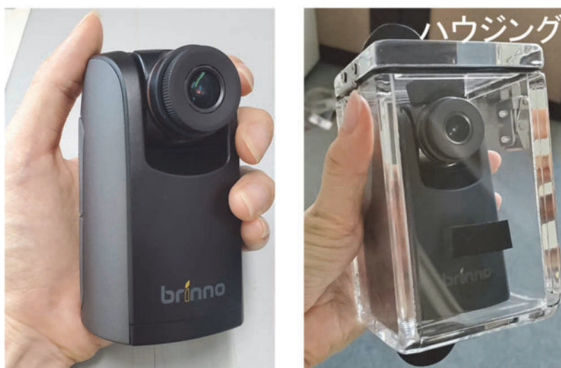
図表 5 (1) 3. ②-1 使用したタイムラプスカメラとハウジング
