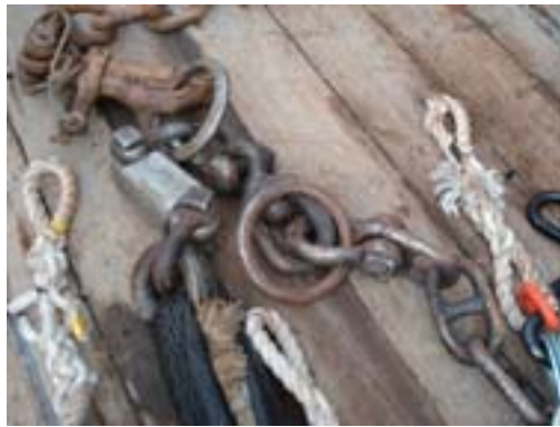
図7 網ペンネット先端に取り付けた水中ロードセル（右舷用）
