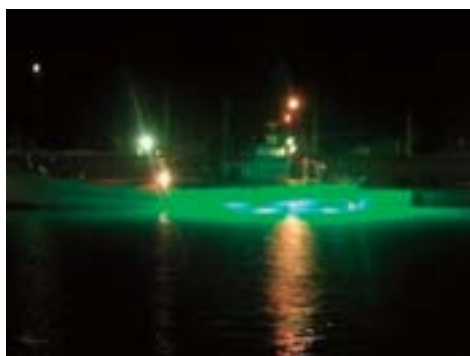
【漁港内での光力測定状況：LED 水中集魚灯（左） ハロゲン水中集魚灯（右）】
