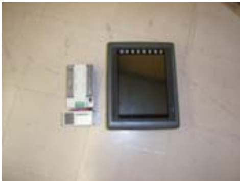
写真3 電力表示器、周辺機器
