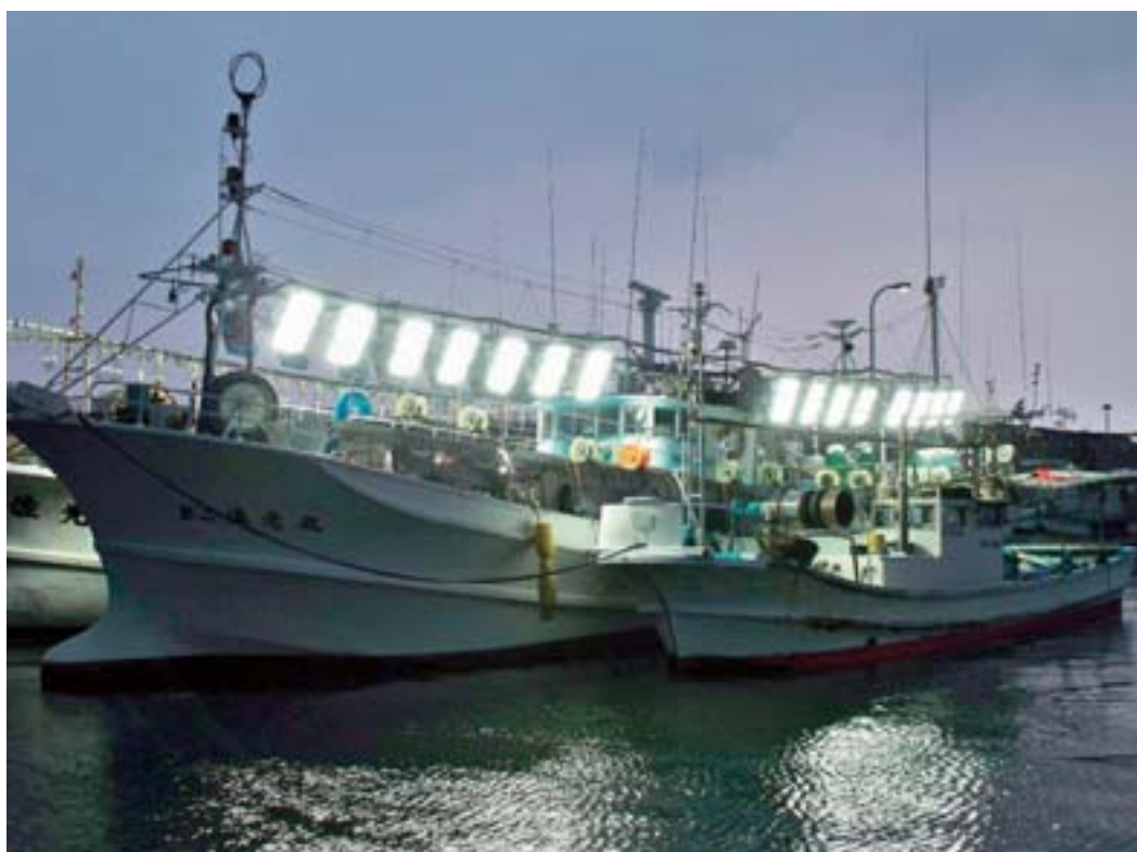
「写真6：電磁誘導灯の点灯-1」
