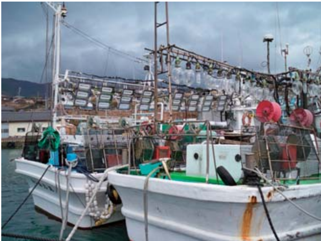
「写真2：メタハラ灯と電磁誘導灯の形状比較」
