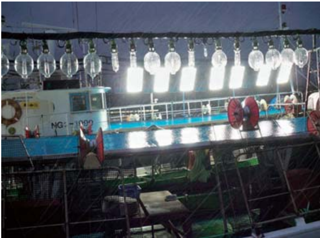
「写真8：電磁誘導灯の点灯-3」
