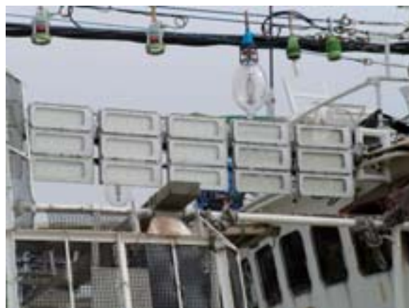
写真 2 LED 漁灯の設置状態
