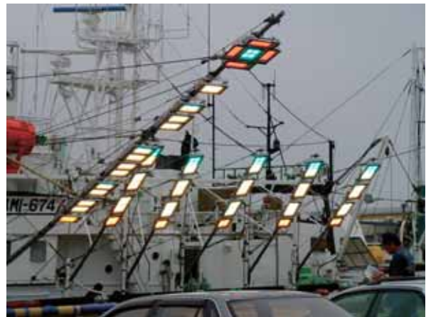
写真5 左舷側の点灯状態
