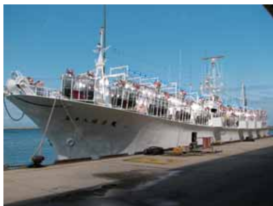
（写真 3）LED集魚灯設置写真
