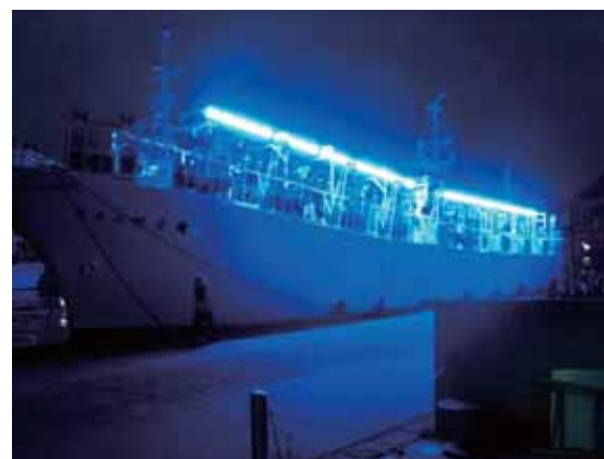
（写真 3）LED集魚灯設置写真
