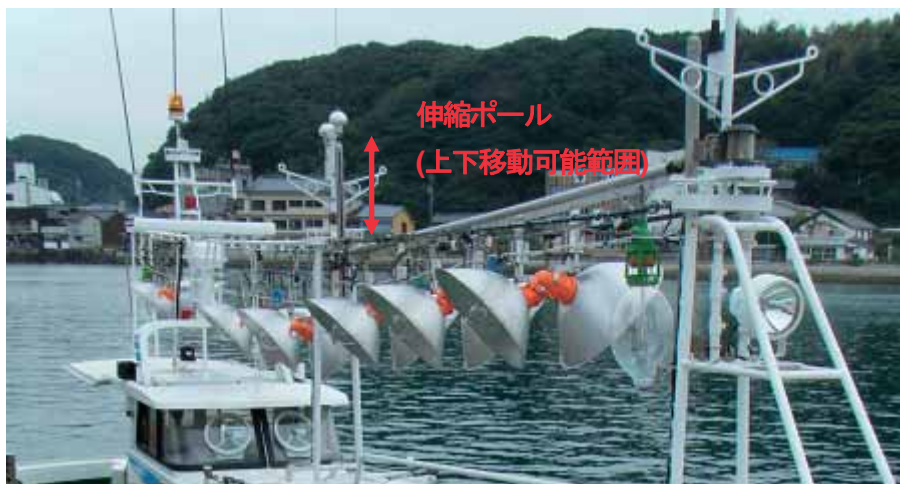
図 2-2 試験船に取り付けた改良型集魚灯と耐震装置、伸縮ポール
