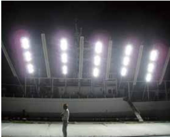
H I D5 竿点灯状況
