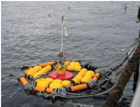
写真5 アンテナ通信部.
