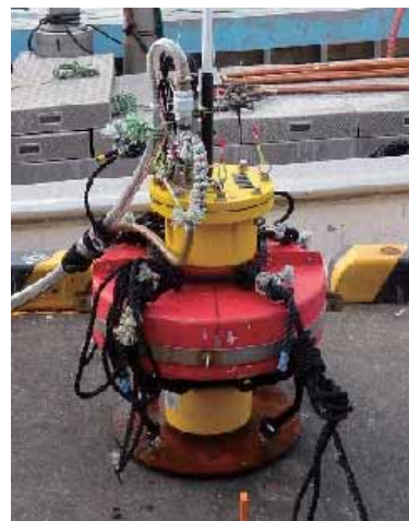
写真9 アンテナ通信部.
