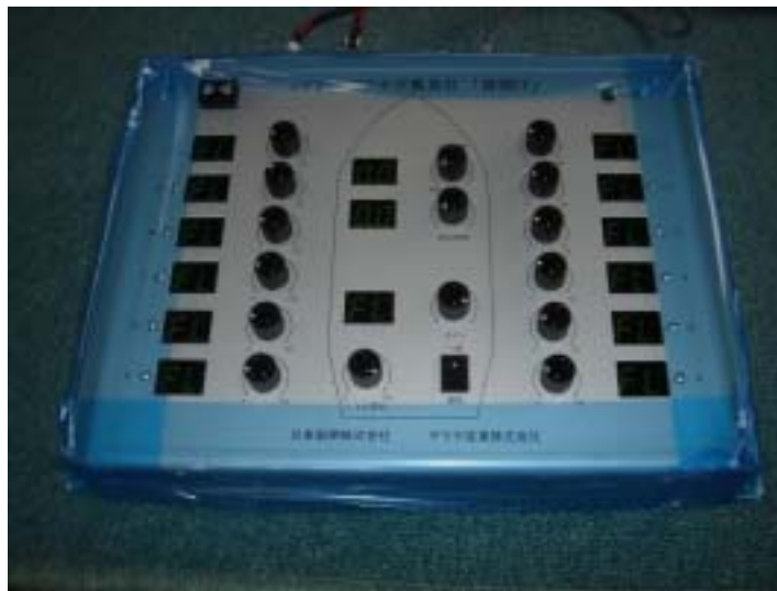
図 12 LED 水中集魚灯調光用操作パネル
